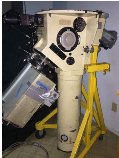
Instrumento Boller & Chivens con CCD E2V-BL-1 instalado.
